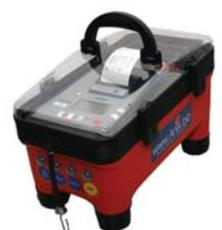
Die Auswertelektronik AX<sup>®</sup> 03 für Ihren vorhandenen Profilografen ermöglicht auf einfache Weise die Bestimmung des Querprofils von Fahrbahnoberflächen.
